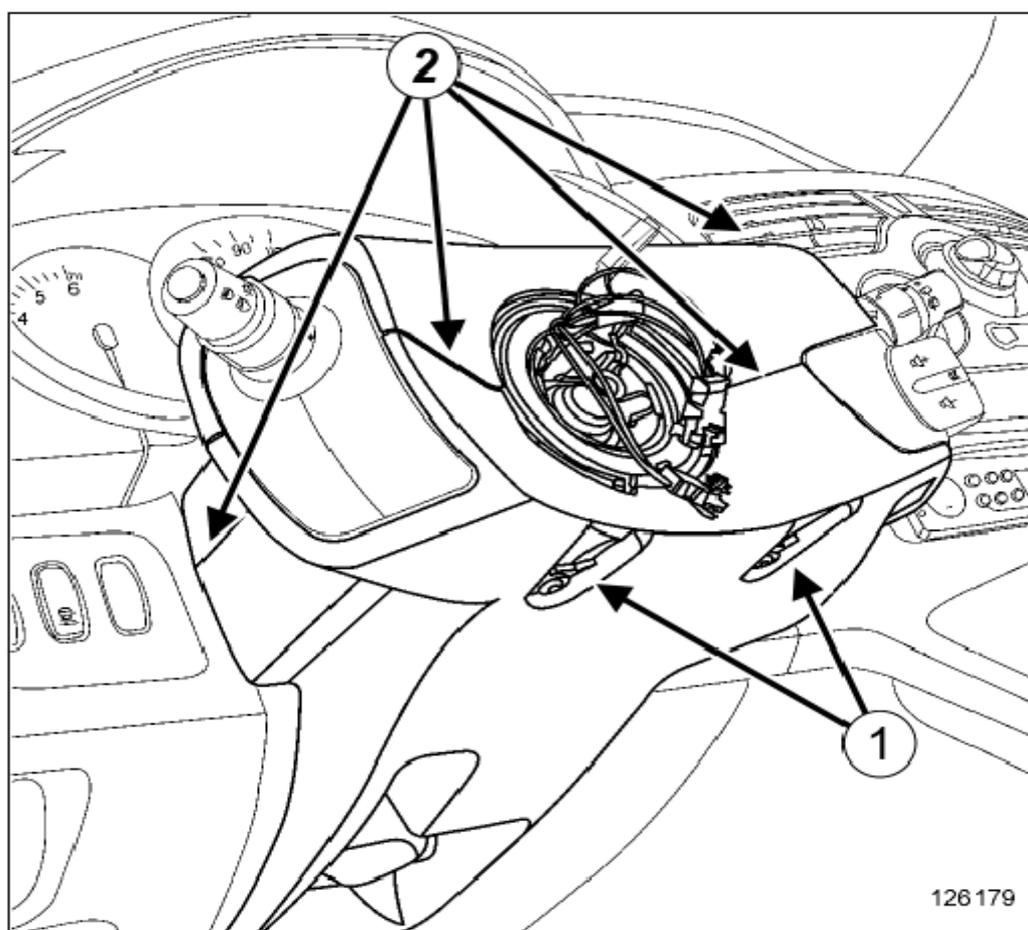
Откройте болты 1, снимите кожухи 2 надавив на защелки.
