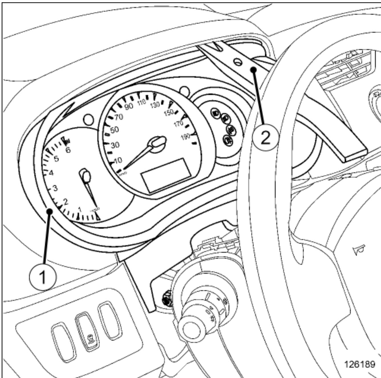
■ Отсоедините облицовку щитка приборов(1) с помощью приспособления Комплект рычагов для снятия обивки.(Car. 1363) (2) .
