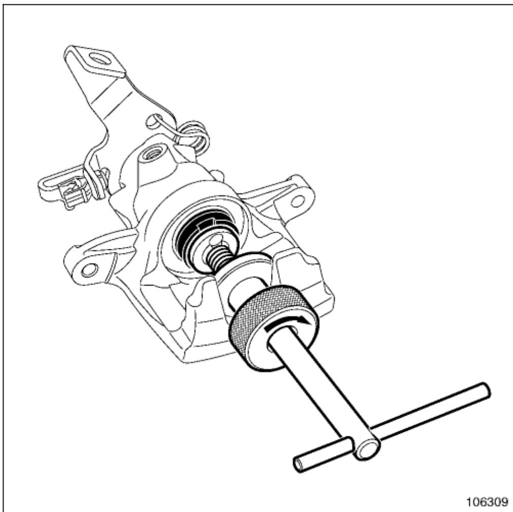
▣ Вдвиньте поршень вглубь гнезда с помощью приспособления Приспособление для перемещения поршня внутрь рабочего цилиндра тормоза.(Fre. 1190-01).
