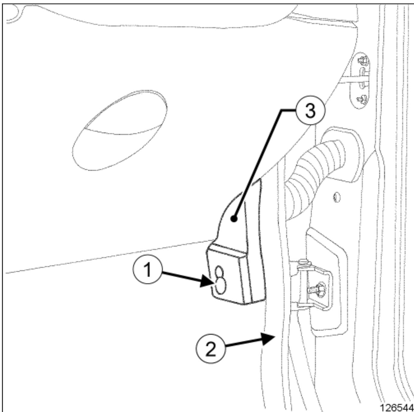
■ Приподнимите фиксатор (1) .
