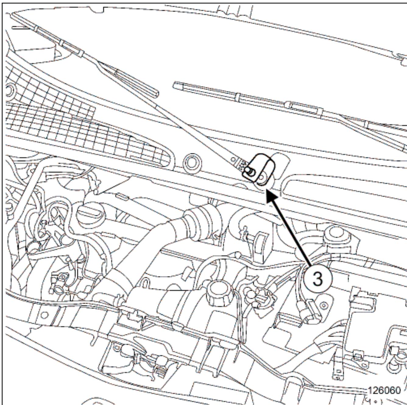
■ Снимите рычаги стеклоочистителя с помощью приспособления Приспособление для снятия рычагов стеклоочистителя (Ele. 1841) (3) .
