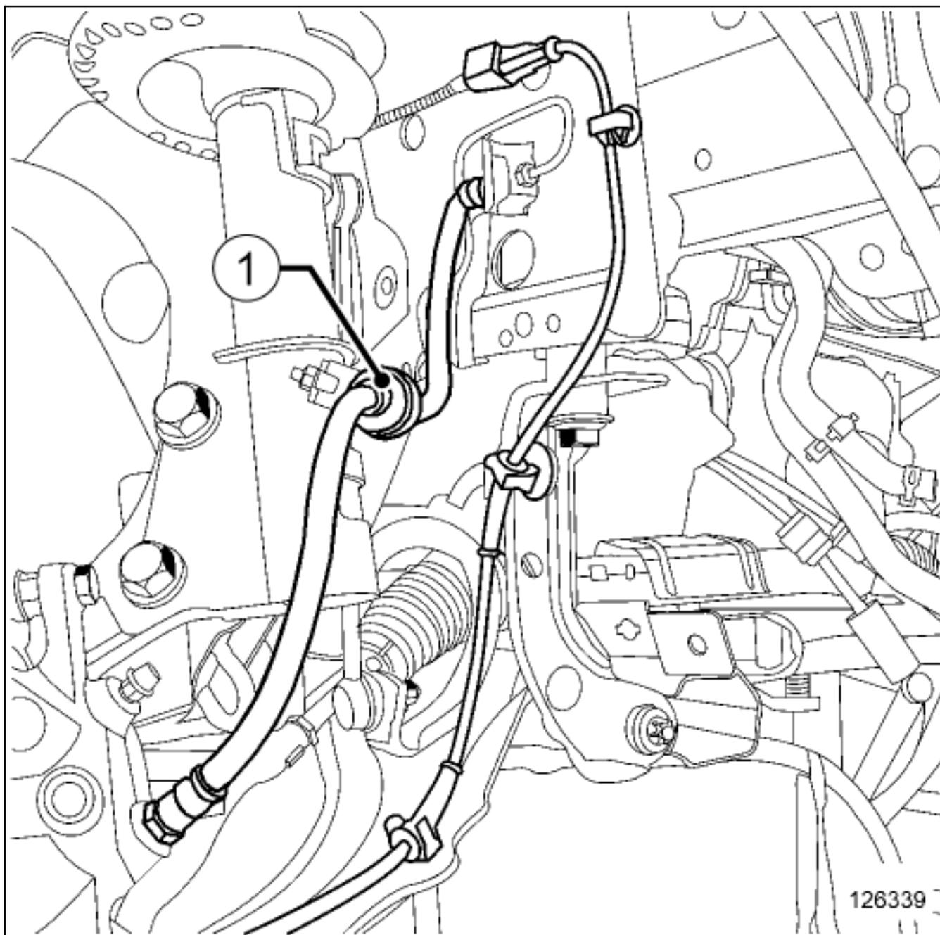
■ Пометьте положение колпачка(1) на амортизаторной стойке с помощью нестираемый карандаш.
