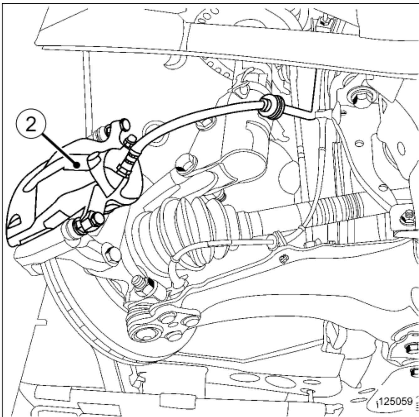
■ Снимите тормозные колодки(см. 31А, [Передние несущие элементы, Передние тормозные колодки: Снятие и установка](#))
