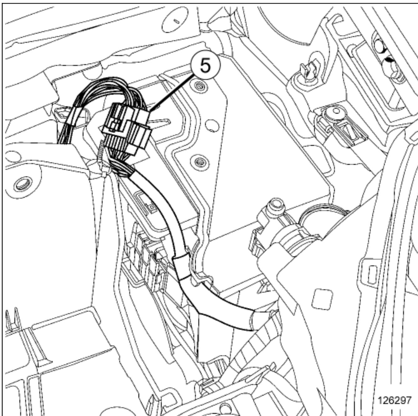
Разъедините разъем блока защиты и коммутации, нажав на фиксатор(5) .
