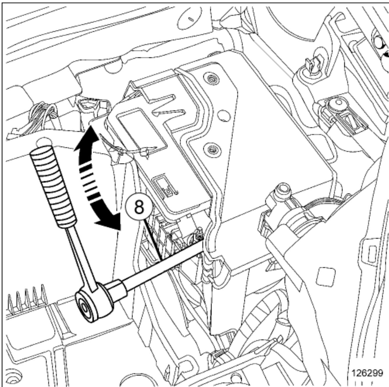
Снимите гайку с корпуса блока защиты и коммутаций с помощью трещотки с удлинителем(8) .
