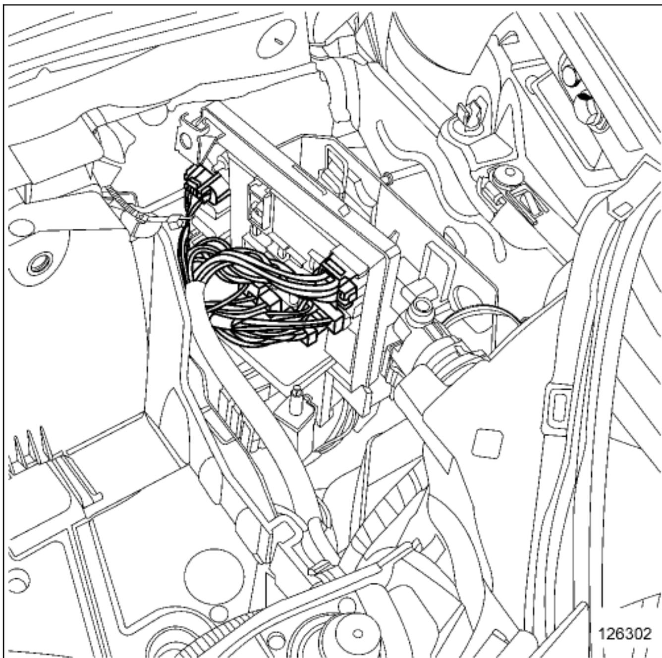
Разъедините разъемы блока защиты и коммутации.
