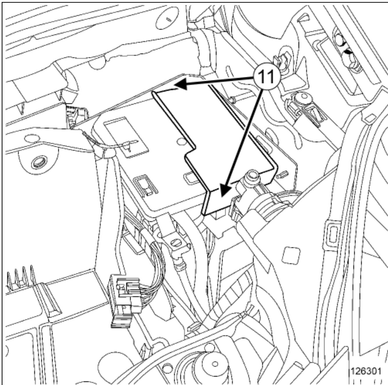
Снимите защитный кожух с блока защиты и коммутации, нажав на фиксаторы(11).
