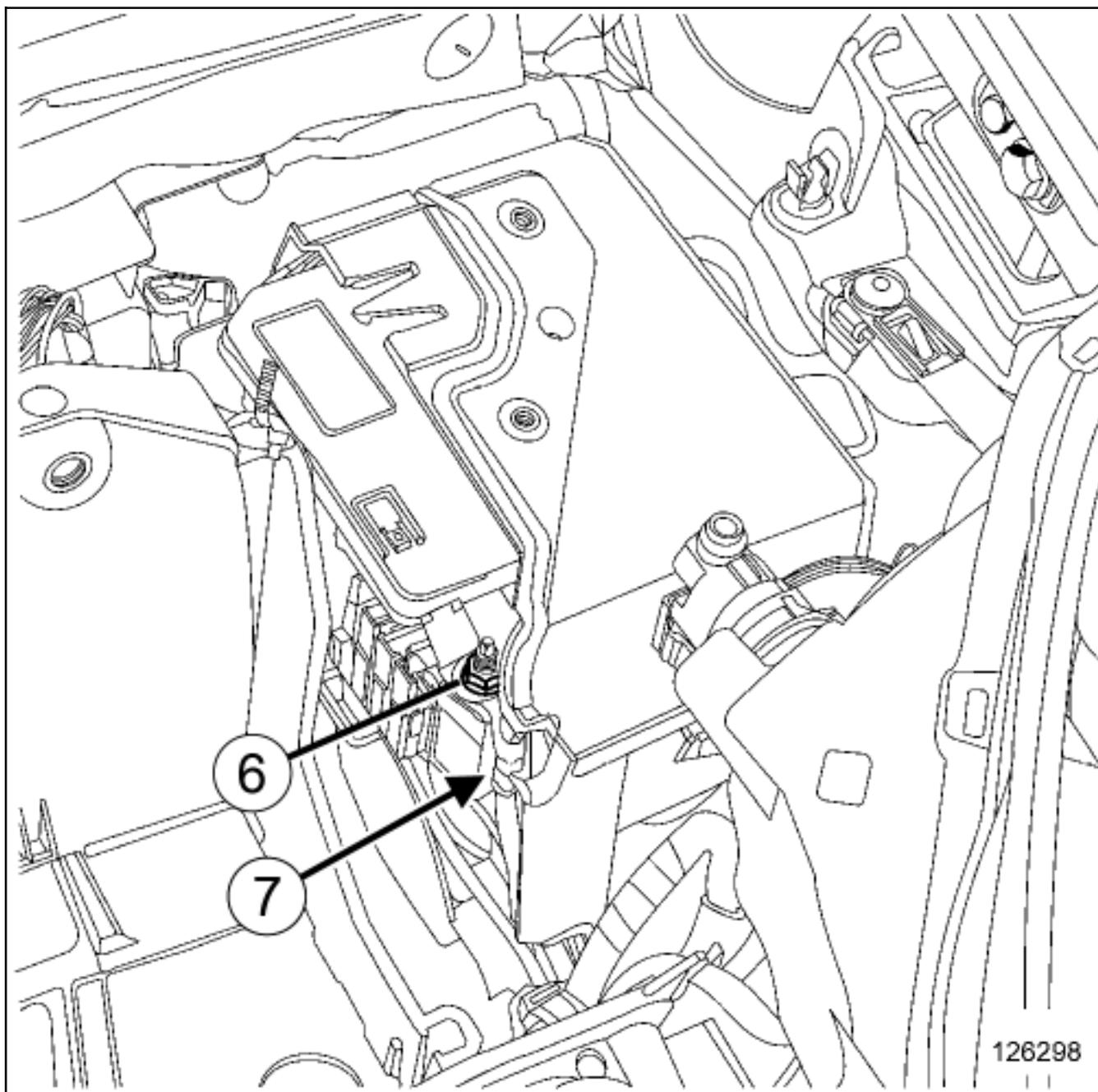
Снимите гайку (6) блока защиты и коммутации.
