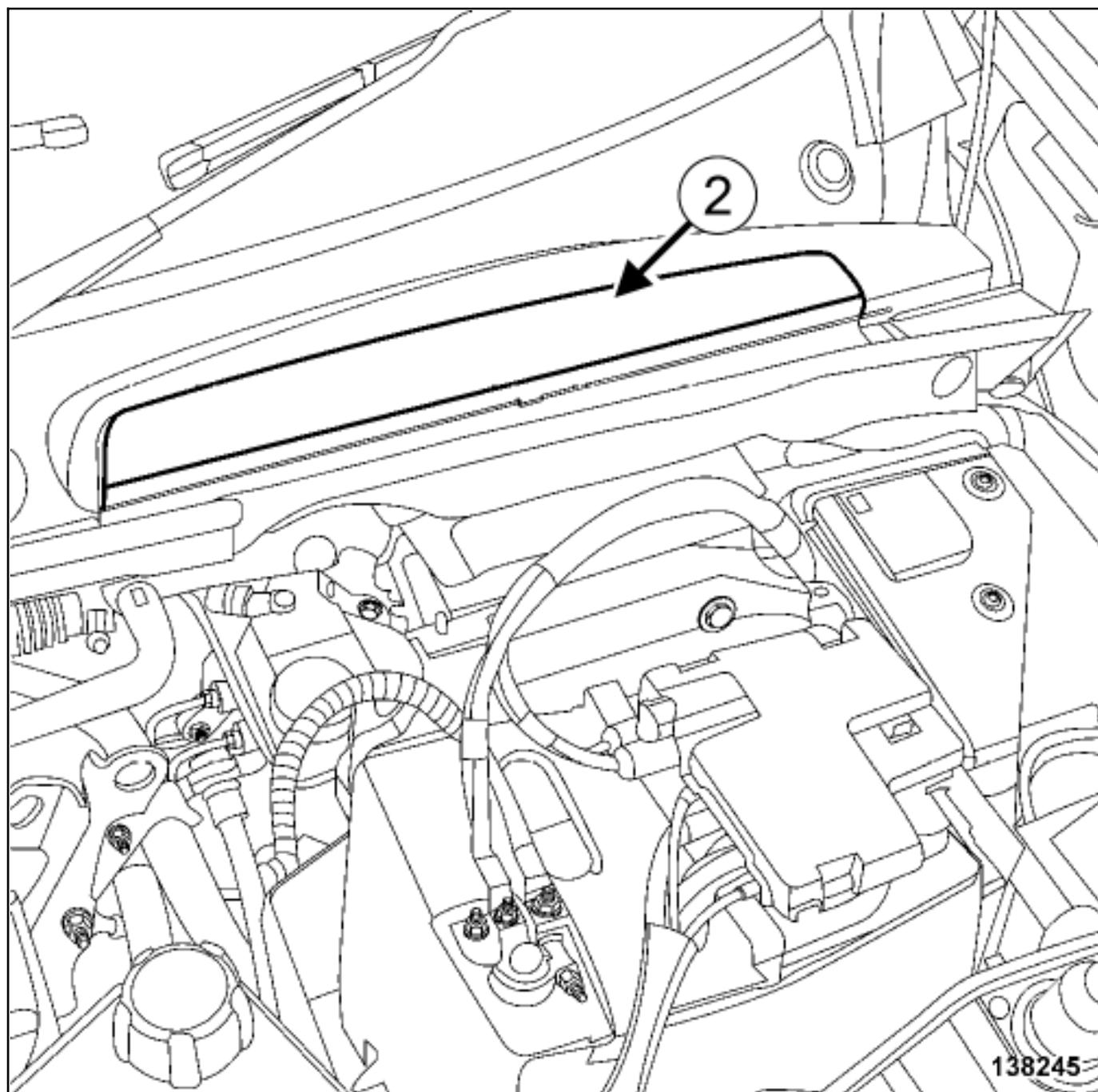
■ Снимите люк доступа(2) к корпусу воздушного фильтра в решетке ниши воздухозабора.
