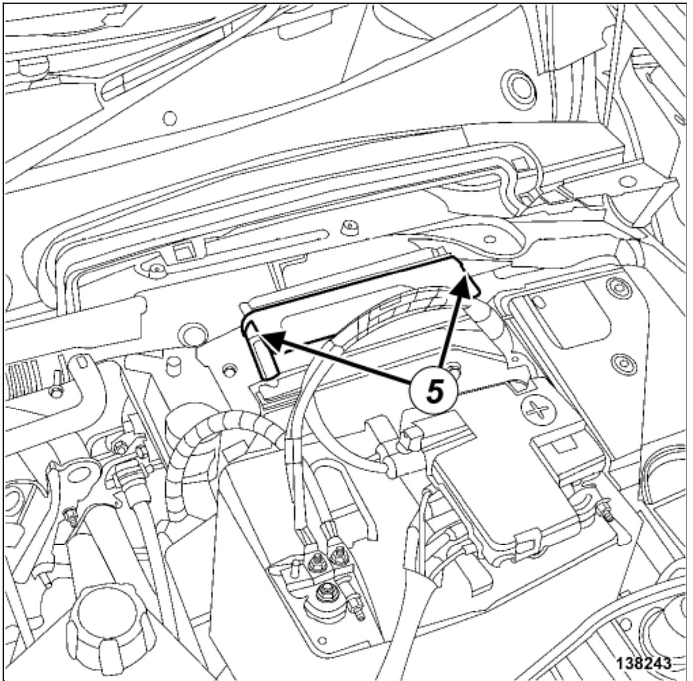
Отверните болты крепления(5) крышки корпуса воздушного фильтра,
