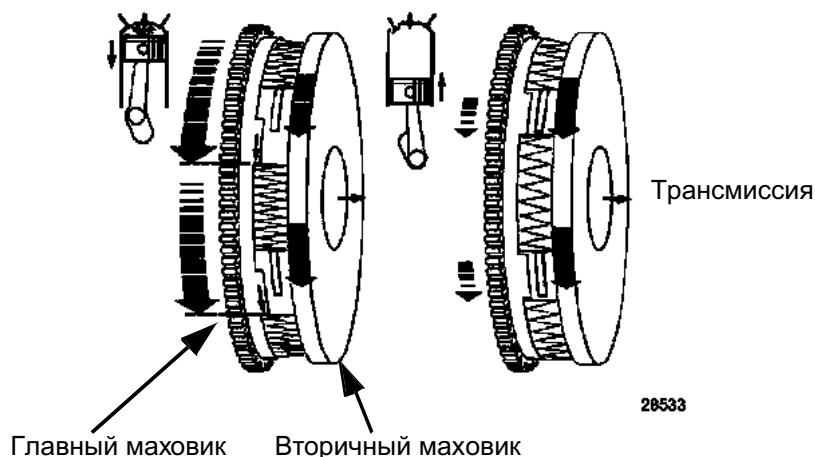
Двойной демпферный маховик может иметь боковой зазор (относительное движение главного и вторичного маховиков) или свободный ход вторичного маховика вокруг оси вращения. Этот зазор называется "рабочим зазором" двойного демпферного маховика.
